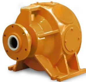
BNA 减速箱可提供从 1100 N m 到最大 19000 N m 不等的扭矩值。其铸铁外壳具有高度的尺寸稳定性，即使在受到强机械和动态应力的情况下也能提供长久的工作寿命。减速箱出厂前均经过润滑，可实现 5 年或 15000 工作小时的使用寿命。
