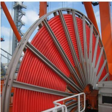
单列螺旋缠绕式盘体将电缆卷绕在同一平面中，能有效地防止电缆扭曲。确保更长的电缆使用寿命。
