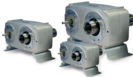
W 型减速箱可提供从 100 N m 到最大 800 N m 不等的扭矩值，此类型的减速箱都安装于防腐蚀铝制外壳内。驱动单元和滑环体与滑环箱空心轴平行，确保尺寸紧凑。
