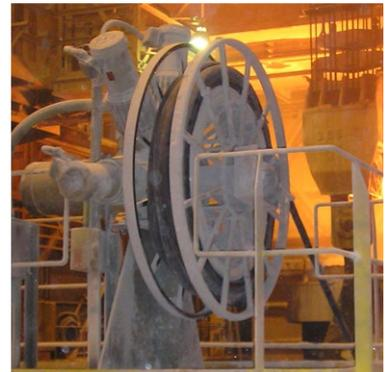
3-2-3 盘体是单列螺旋缠绕式盘体与宽式盘体的结合体，其中电缆将分层堆叠，每层高度与三条电缆的直径相当。
