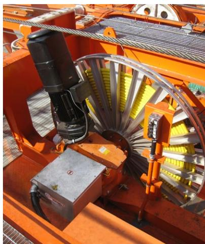
在集装箱和散货港口、炼钢厂、剧院、废水处理厂和矿山，Conductix-Wampfler 电动卷筒都能可靠地满足严苛的要求，即使在恶劣环境条件下也是如此。
