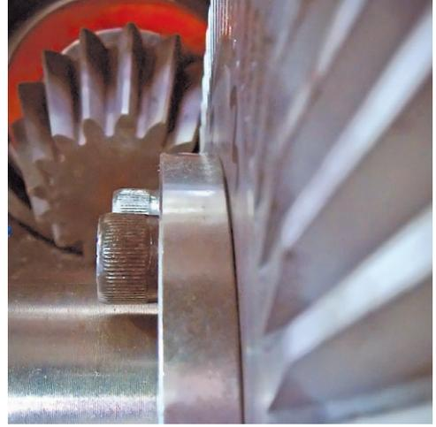
减速箱承载整个卷筒系统，根据应用工况提供精确的转速和力矩。
